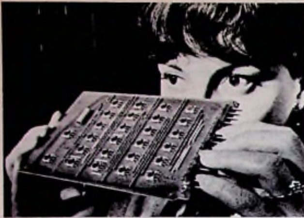
In de derde generatie worden IC's op printkaarten zodanig doorverbonden dat complexere functies ontstaan.
